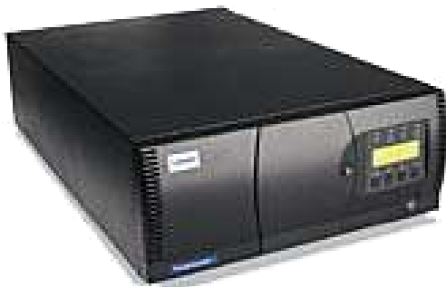
Dieser Autoloader verwaltet bis zu 19 Kassetten bzw. 3,4 TByte.
